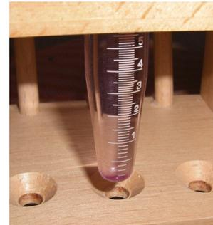
11. Ich wiederhole den Arbeitsvorgang mit Methylenblau und wegen des besseren Kontrastes erkenne ich ca. 2 $\mu\text{l}$  Sediment in der Messpipette.
