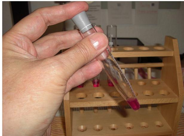
Das Bild zeigt das, aus den vier Resten der Zentrifugengläser zusammen geschüttetem, neue Zentrifugenglas. Daneben steht das mit Leitungswasser gefüllte Glas als Gegengewicht bei der Zentrifuge
